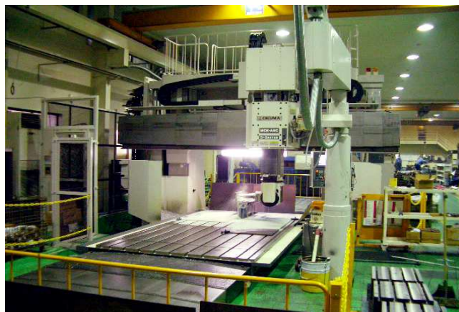
オークマ五面加工機 MCR-A5C 4000×2000×650
