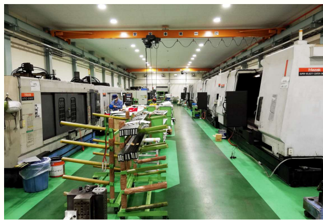
長尺縦マシニングセンター 5000×500 2台 3000×500 4台 2000×500 4台
