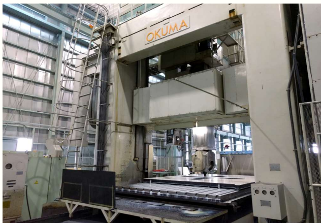
オークマ五面加工機 MCR-30E 5000×3050×2000
