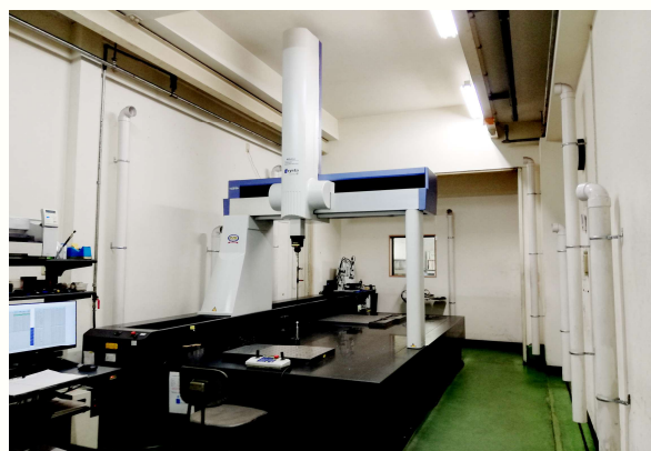
ミツトヨ三次元測定器 CRT-AC123010 最大測定寸法 1205×3005×1005
