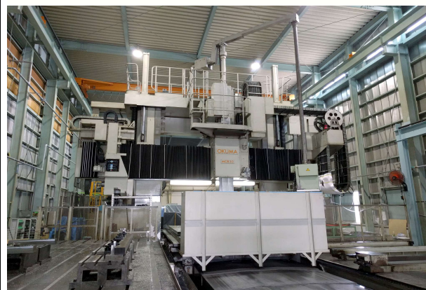
オークマ五面加工機 MCR-30E 5000×3050×2050
