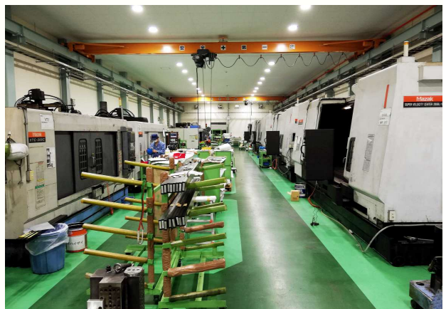
長尺縦マシニングセンター 5000×500 2台 3000×500 4台 2000×500 4台
