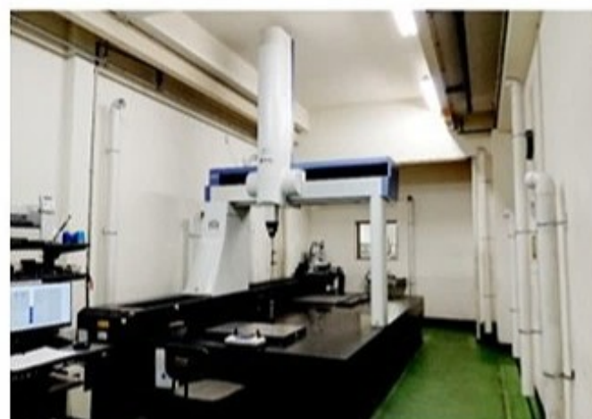
ミットヨ 三次元測定器 CRT-AC123010 (1205×3005×1005)
