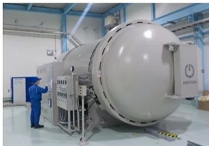
羽生田 オートクレーブ ( \phi 2500×4000L)
