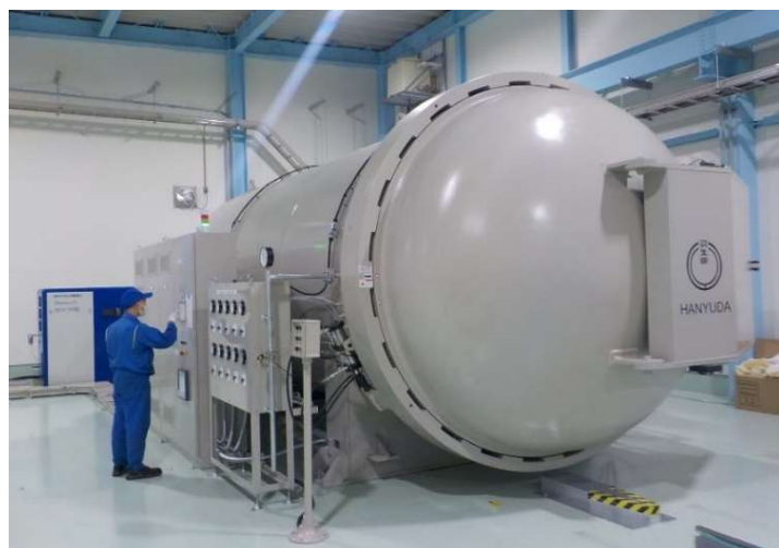
第二工場オートクレーブ (φ2500×4000L) (羽生田)
