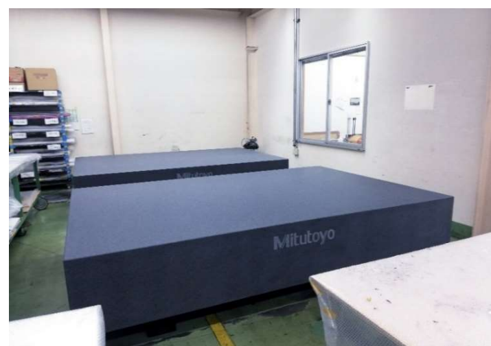
第二工場CFRP成形・測定用石定盤 (2000×3000)×2 (ミットヨ)
