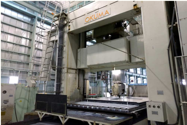
オークマ五面加工機 MCR-30E 5000×3050×2000
