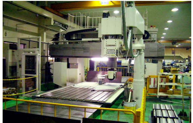
オークマ五面加工機 MCR-A5C 4000×2000×650
