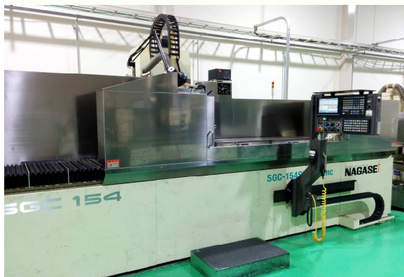
ナガセインテグレックス平面研削盤 SGC154SLS2 最大研磨寸法 1700×440
