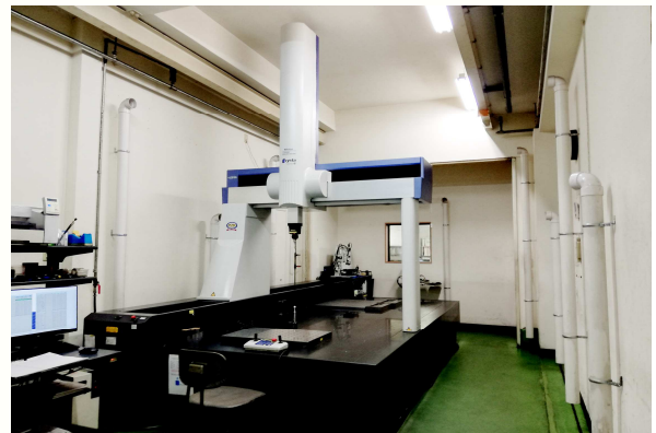
ミトヨ三次元測定器 CRT-AC123010 最大測定寸法 1205×3005×1005
