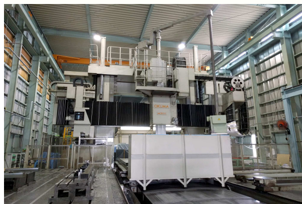
オークマ五面加工機 MCR-30E 5000×3050×2050
