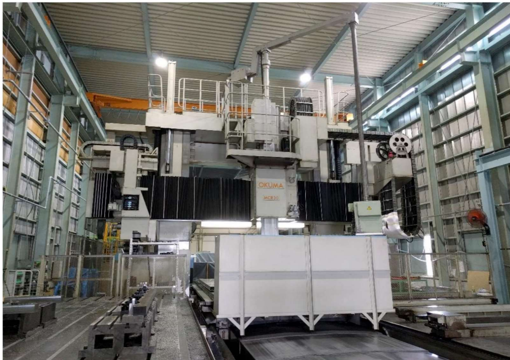
オークマ五面加工機 MCR-30E 5000×3050×2050
