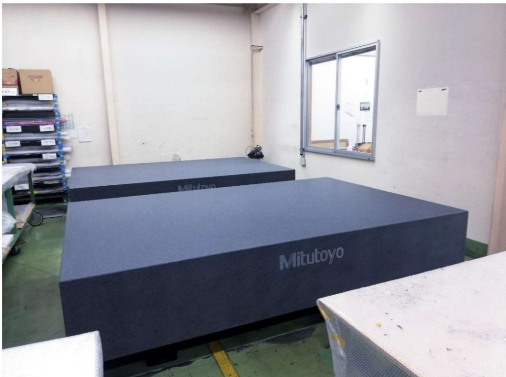
第二工場CFRP成形/測定用石定盤 2000×3000…2台
