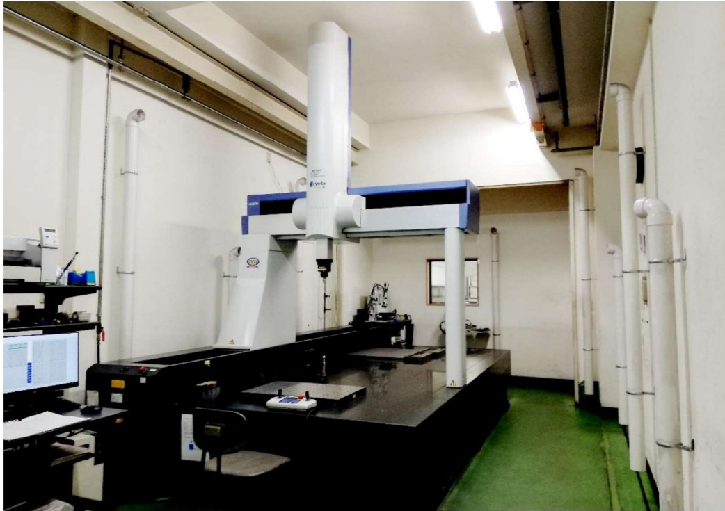
本社工場三次元測定器 ミットヨ CRT-AC123010 1205×3005×1005
