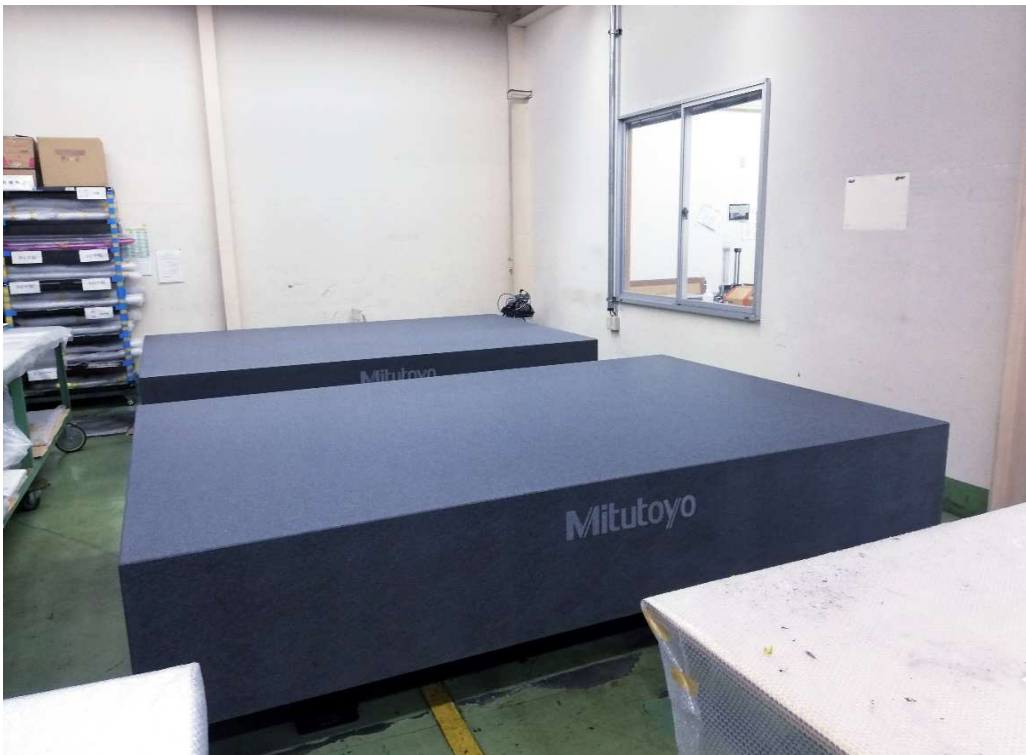
第二工場CFRP成形/測定用石定盤 2000×3000…2台
