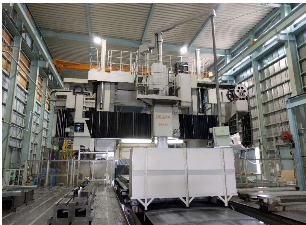
オークマ五面加工機 MCR-30E 5000×3050×2050
