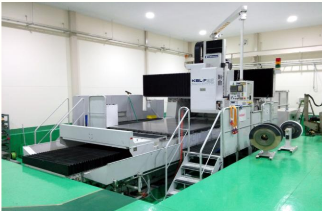
住友重機械工業平面研削盤 KSL-F2230(H) 最大研磨寸法 2200×4000
