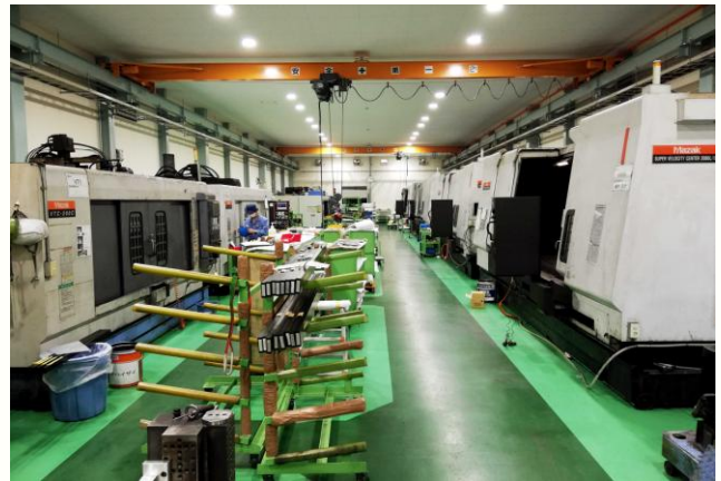
長尺縦マシニングセンター 5000×500 2台 3000×500 4台 2000×500 4台
