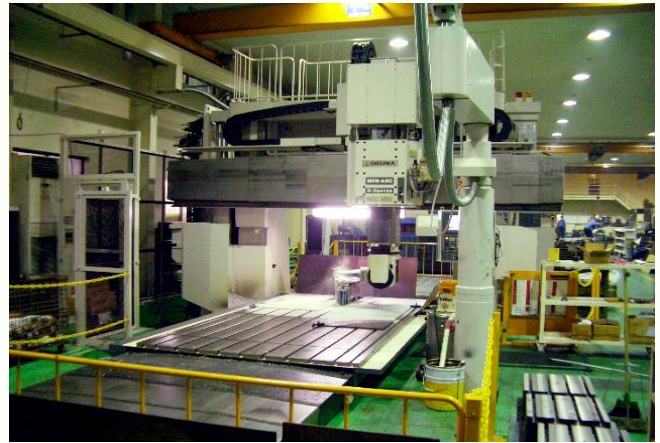
オークマ五面加工機 MCR-A5C 4000×2000×650
