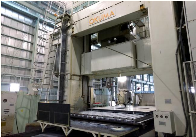
オークマ五面加工機 MCR-30E 5000×3050×2000
