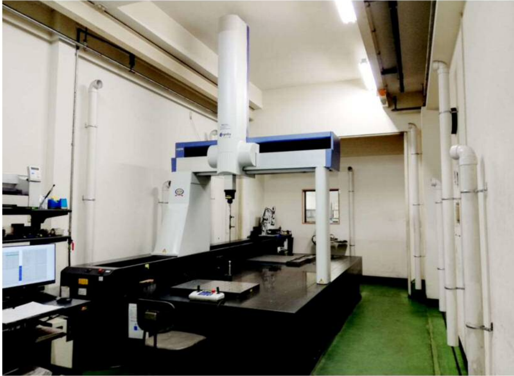
本社工場三次元測定器 ミットヨCRT-AC123010 1205×3005×1005
