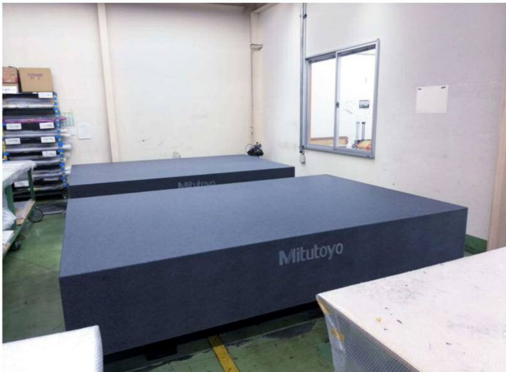
第二工場CFRP成形/測定用石定盤 2000×3000…2台
