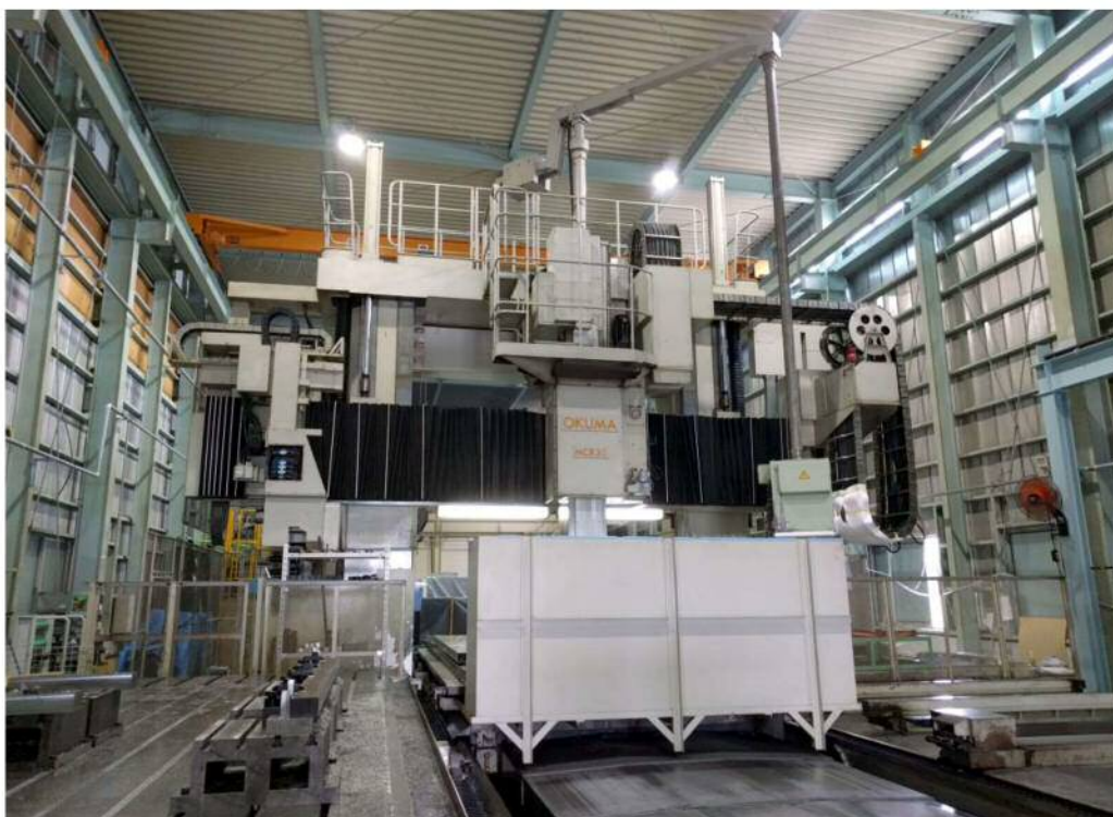
オークマ五面加工機 MCR-30E 5000×3050×2050
